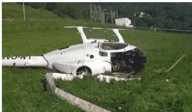
Selhání hydrauliky způsobilo nouzové přistání Svena, jež vyústilo v těžkém poškození helikoptéry.
